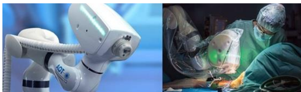
Figure 4 : dispositif laser robotisé CARLO utilisé pour la découpe de l'os (© AOT).
