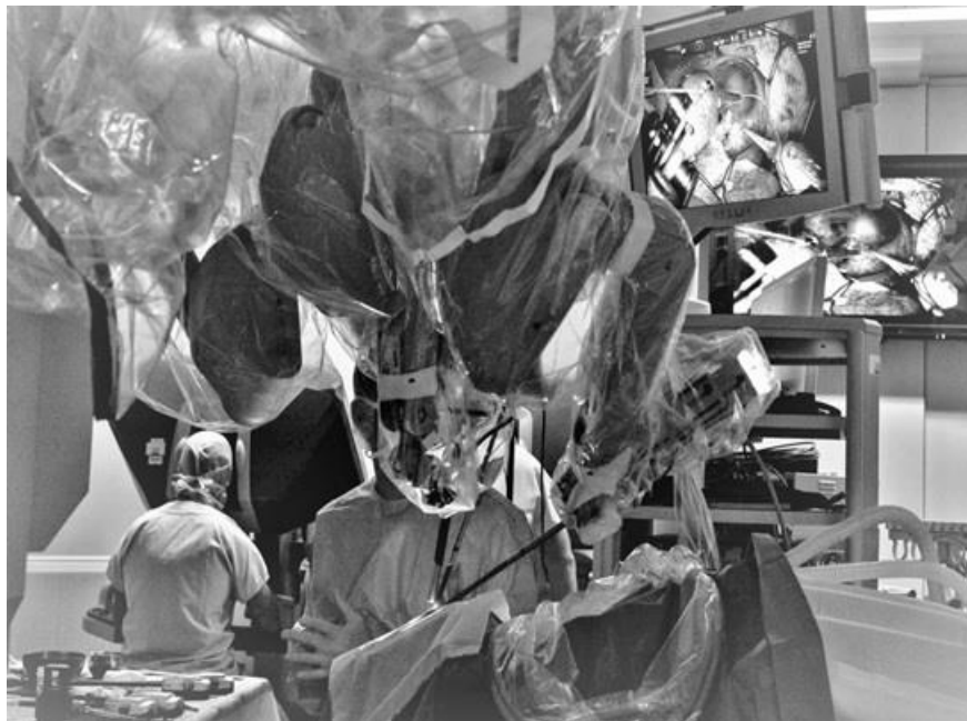
Figure 1 : La partie mobile du Da Vinci™ au bloc opératoire (IHU de chirurgie guidée par l'image, Hôpitaux Universitaires de Strasbourg). Elle est placée derrière la tête du patient installé en décubitus dorsal (premier plan). Elle comprend 4 bras articulés, 3 d'entre eux sont chargés des différents instruments chirurgicaux et le 4ème est équipé de la caméra digitale stéréoscopique installée verticalement au-dessus de l'œil à opérer et qui permet au chirurgien installé à distance à sa console de visualiser le champ opératoire (arrière-plan). Les bras du robot sont positionnés à la partie inférieure et temporale du visage afin d'éviter les contacts avec le nez et le toit de l'orbite. Ils sont inclinés de 45 à 60 degrés par rapport au plan chirurgical et organisés de façon triangulaire. Un(e) infirmier(e) roboticien(ne) et un interne sont présents à proximité du patient. Habillés stérilement, ils ont pour mission de changer les instruments et d'arroser la surface oculaire quand cela est nécessaire.
