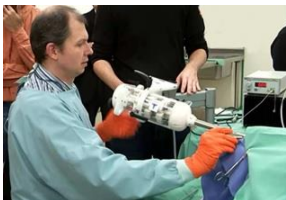
Figure 3 : Dispositif laser robotisé pour la phonomicrochirurgie (© \mu RALP).
